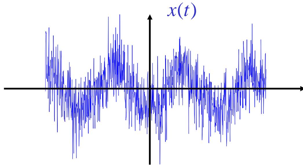
Le componenti del segnale **rapidamente variabili nel tempo** (ad alta frequenza) vengono eliminate dalla convoluzione con una risposta all'impulso **lentamente variabile nel tempo** (filtro passa-basso)
