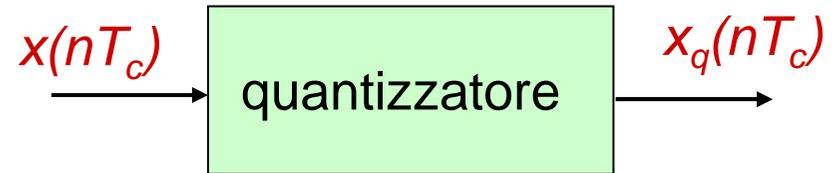
Ad esempio se il minimo e il massimo valore che può assumere il campione  $x(nT_c)$  sono  $-V$  e  $V$ , la relazione tra il valore continuo  $x(nT_c)$  e quello quantizzato  $x_q(nT_c)$  è rappresentata da una scalinata con  $M_Q$  livelli:  $x_q(nT_c)$  sarà il valore centrale dell'intervallo in cui cade il campione  $x(nT_c)$
