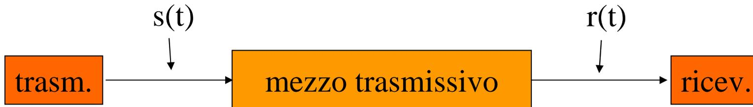
Nei sistemi di comunicazione, normalmente, il mezzo trasmissivo è caratterizzato dalla propagazione di onde elettromagnetiche.
